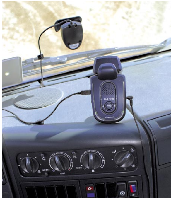
Leicht zu installieren: Das Spurverlassens-warnsystem FAS 100
